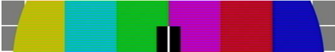
Σχήμα 2.11: Αποτελέσματα μεγάλων σφαλμάτων στη φάση (Hanover Bars)
