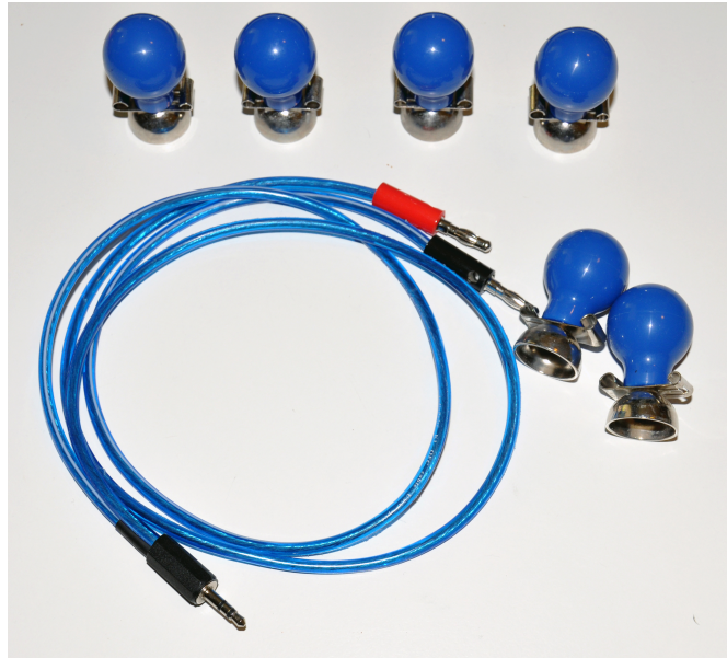
Σχήμα 7.6: Στεγνά ηλεκτρόδια και η καλωδίωση που χρησιμοποιήθηκε για την καταγραφή καρδιογραφήματος
