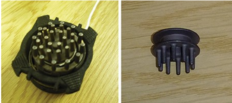
Σχήμα 3.4: Ηλεκτρόδια επαφής με καρφάλια (pins) τα οποία βοηθάνε να εισχωρήσουν μέσα στα μαλλιά και να ακουμπήσουν δέρμα στο κεφάλι ώστε να αποκτήσουν καλό EEG
