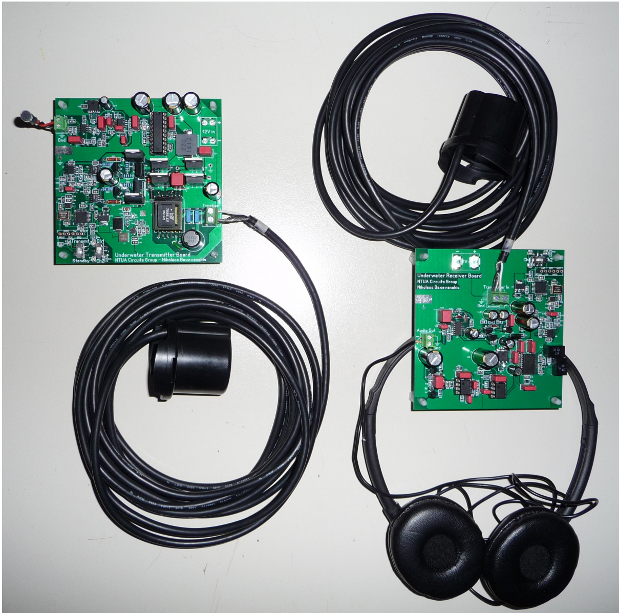
Σχήμα 5.14: Το πλήρες σύστημα επικοινωνίας: κάθε υποσύστημα συνδέεται σε έναν από τους δύο υπερηχητικούς μετατροπείς 200LM450 της Prowave ® , ενώ το σύστημα εκπομπής (αριστερά) διαθέτει ένα μικρόφωνο, και το σύστημα λήψης (δεξιά) ένα ζεύγος ακουστικών (σε mono λειτουργία)
