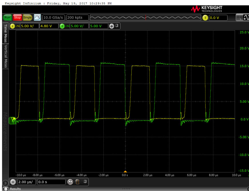
Σχήμα 5.3: Τα μη επικαλυπτόμενα ρολόγια που οδηγούν τη γέφυρα: πλάτος 0-15 V, και συχνότητα 198 kHz (κανάλι 1)
