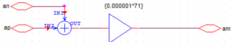
Σχήμα 2.5: α) Διάταξη προσομοίωσης a_n στο SPICE, β) Διάταξη προσομοίωσης a_p στο SPICE και γ) Διάταξη προσομοίωσης a_m στο SPICE
