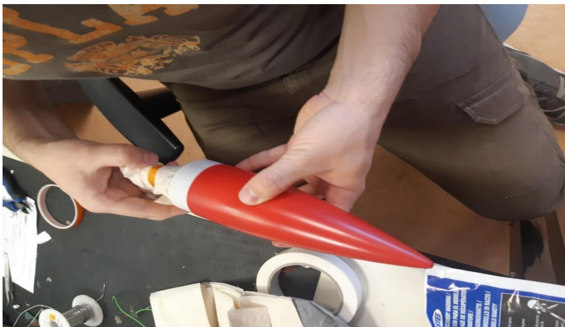
Σχήμα 6.4 : Τοποθέτηση της πλακέτας στη μύτη του πυραύλου
