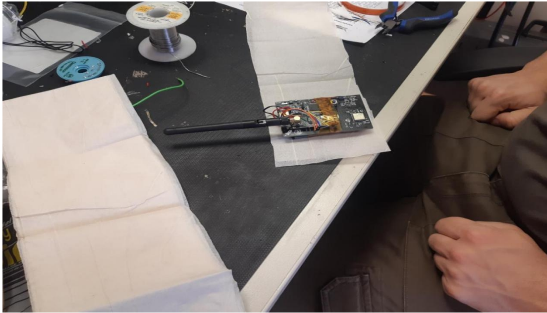
Σχήμα 6.3 : Διαδικασία περιτύλιξης της πλακέτας με πυρίμαχο υλικό
