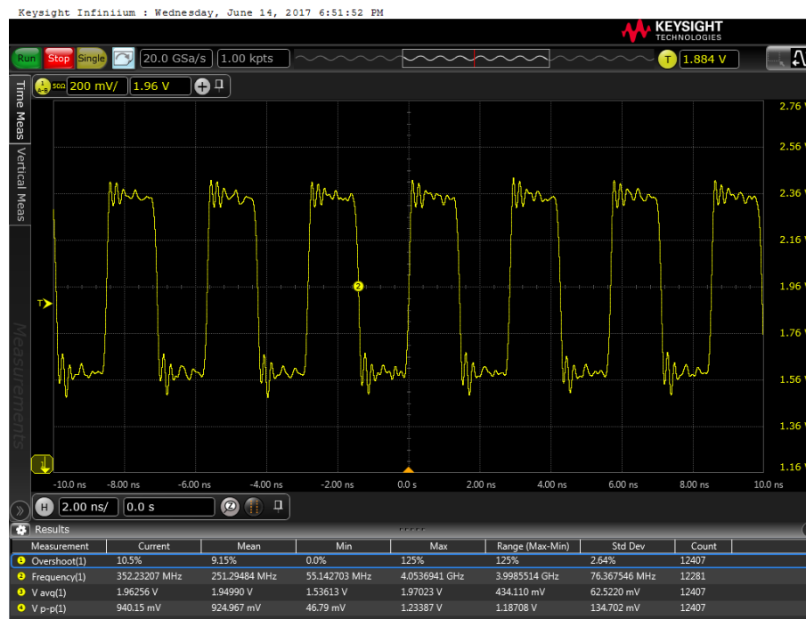
Σχήμα 5.4: Το διαφορικό σήμα στην έξοδο του D Flip-Flop στη συχνότητα των 350 MHz.
