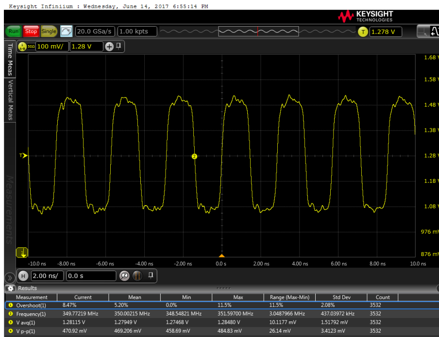
Σχήμα 5.2: Το διαφορικό ρολόι του FPGA στη συχνότητα των 350 MHz.
