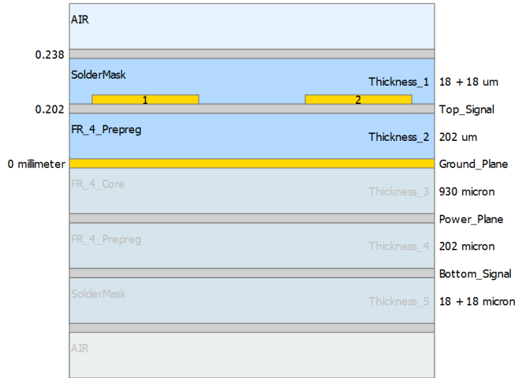
Σχήμα 4.32: Μοντέλο του PCB για τον υπολογισμό των edge-coupled microstrip .
