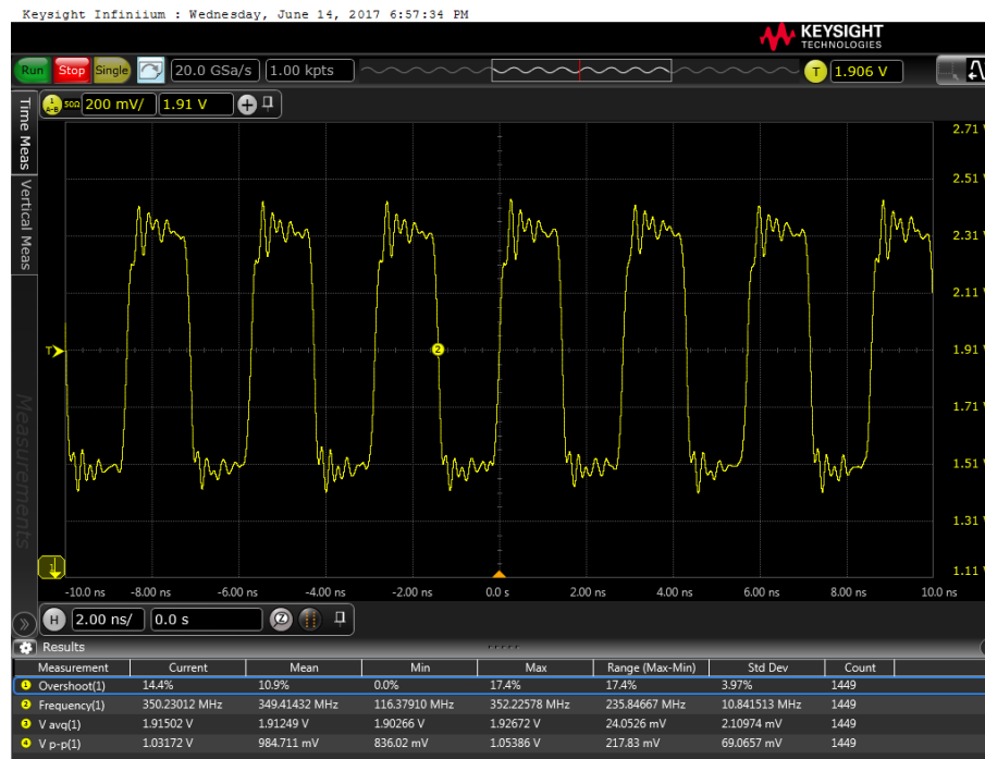
Σχήμα 5.3: Το διαφορικό ρολόι του D Flip-Flop στη συχνότητα των 350 MHz.
