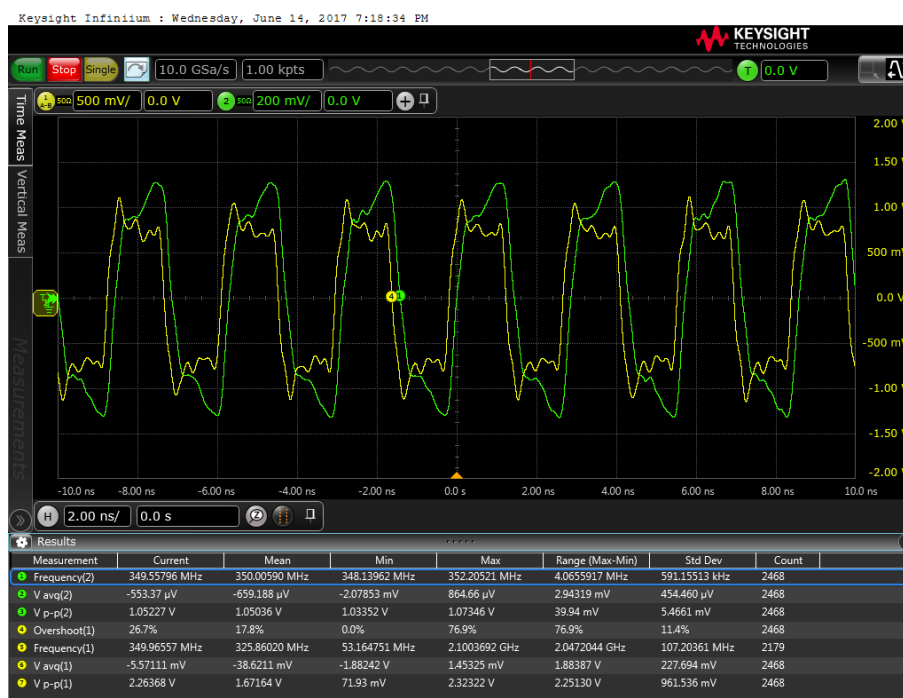
Σχήμα 5.5: Στο κανάλι 1 (κίτρινο χρώμα) φαίνεται το σήμα πληροφορίας στην είσοδο του balun μετασχηματιστή MABA-011029. Στο κανάλι 2 (πράσινο χρώμα) φαίνεται η έξοδος του 1-bit DAC. Η συχνότητα των σημάτων είναι 350 MHz.
